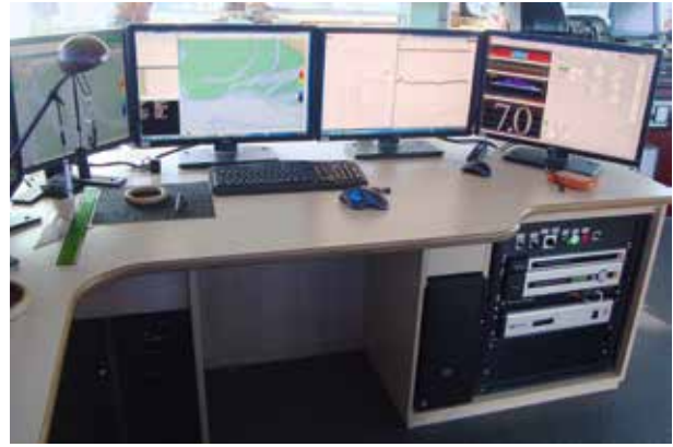
Messarbeitsplatz an Bord eines Vermessungsschiffs
